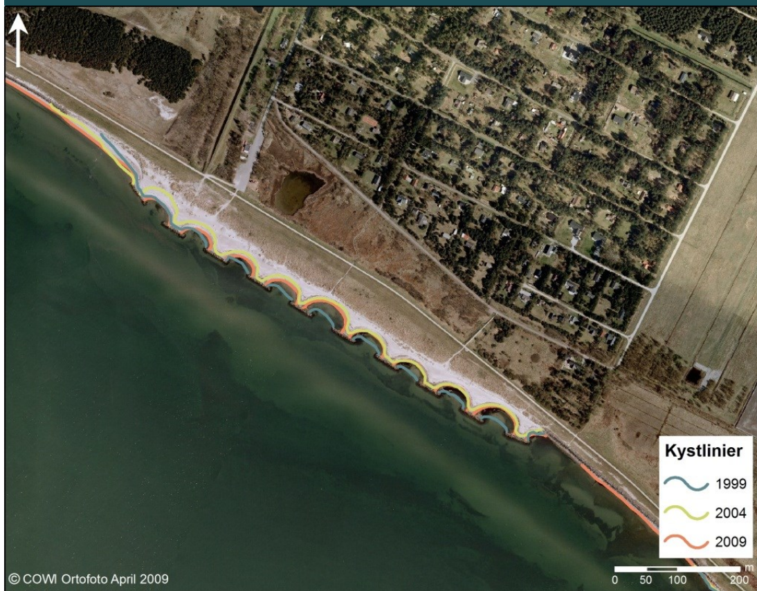
FIGUR 10.1.4-12 Bølgebrydere og kystlinjeændringer mellem 1999 - 2009 ved Hyldtofte Østersøbad
