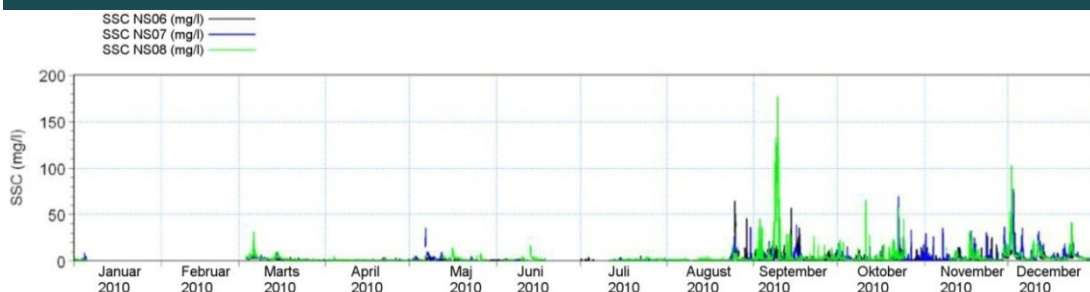
FIGUR 10.1.2-25 Tidserier for koncentrationen af suspenderet sediment for de kystnære stationer ved Fehmarn, stationerne NS06, NS07 and NS08
