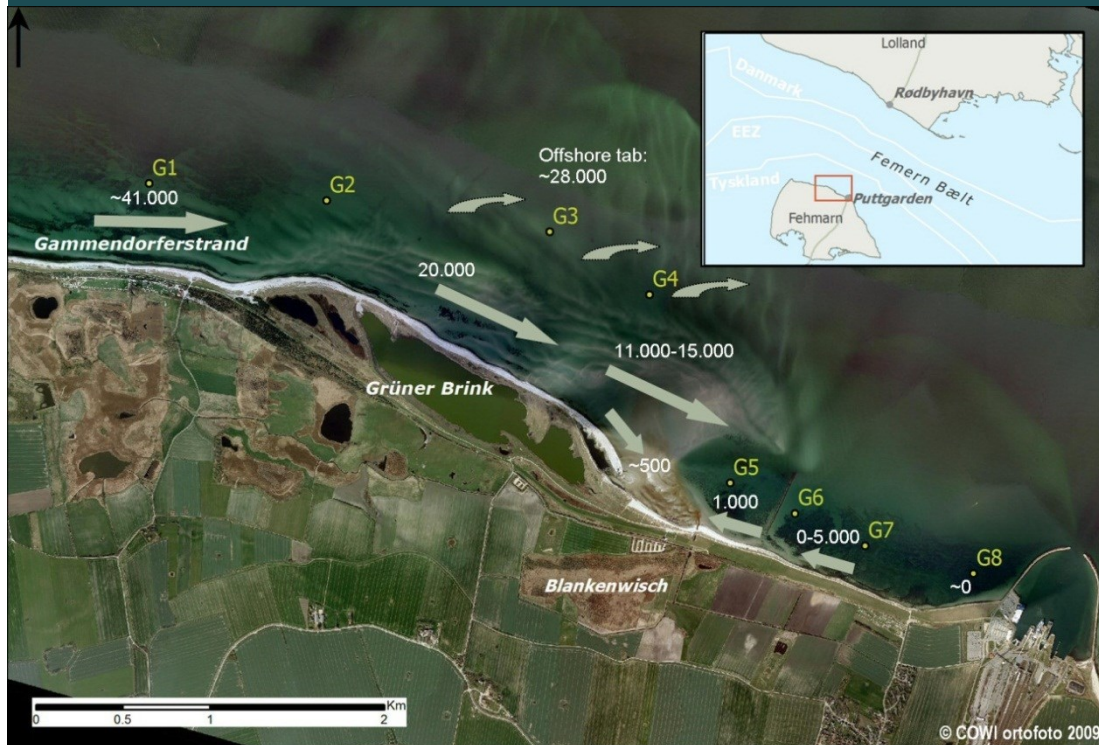
FIGUR 10.1.4-38 Sedimentbudget (m 3 pr. år) for kysten vest for Puttgarden baseret på LITDRIFT-modelberegninger
