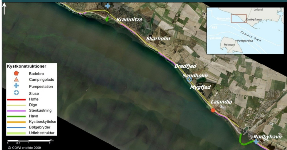
FIGUR 10.1.4-8 Oversigt over kystkonstruktioner mellem Kramnitze og Rødbyhavn
