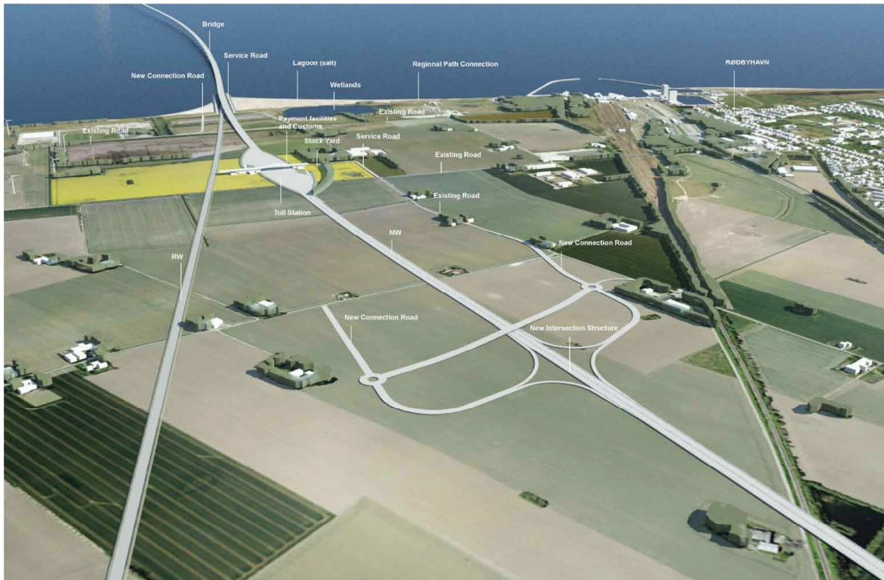
Figur 4.15 Oversigt over broanlæggets komponenter, nye veje mv. på landområdet på Lolland. Karakterområde 8 omfatter landområdet indtil betalingsanlægget. Illustrationen er vejledende (Femern 2010b, 84.1)
